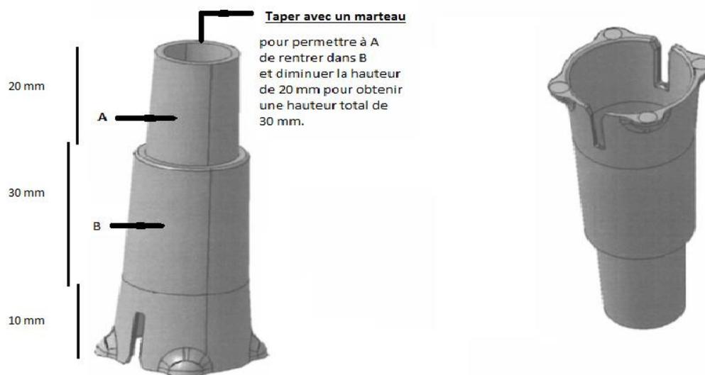
Le pied de Réhausse permet une hauteur totale de la boîte de 200 mm ou de 180 mm.
